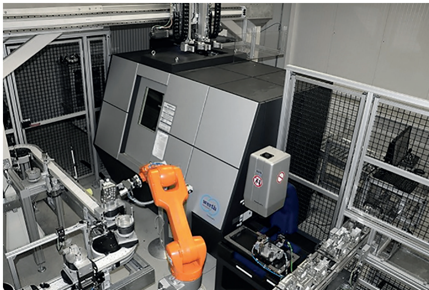
Automatisierte Messzelle mit Roboterbeladung für Inline-Messungen mit Computertomografie.
